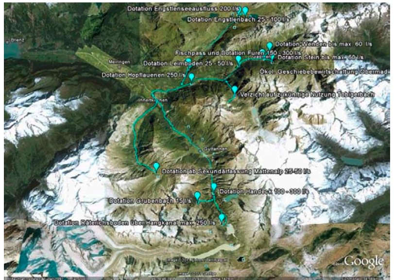
Bild 4: Die gewässerökologischen Massnahmen im Rahmen der KWO-Gewässersanierung. Die blauen Pfeile geben die Restwasserstrecken mit Dotierungen an.
